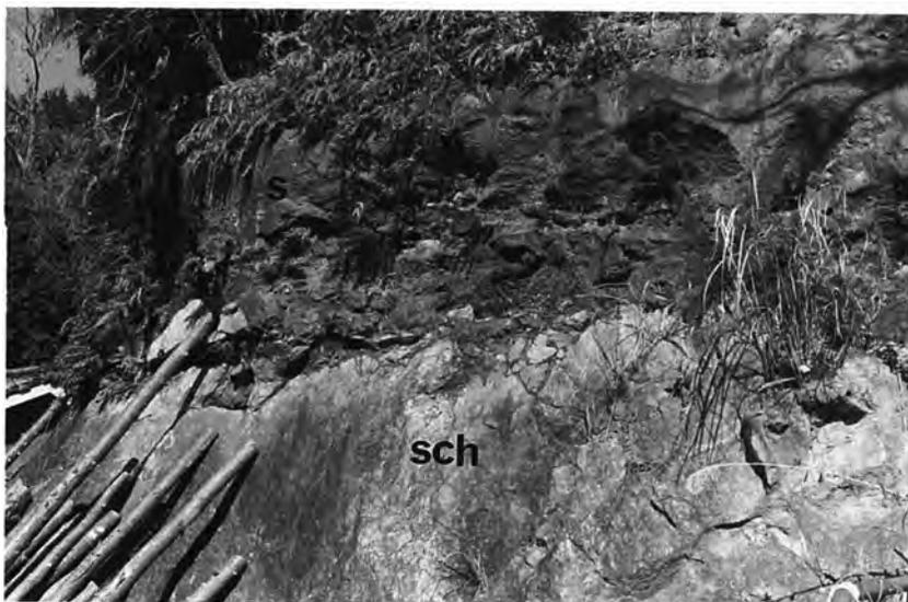
第30図 結晶片岩 (sch) を不整合に被覆する蛎浦層の含礫粗粒砂岩 (s)
