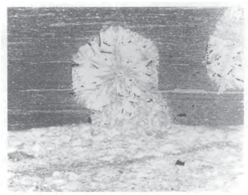
第11図 沖友層の堇青石ホルンフェルスの顕微鏡写真 関前村小大下島南西海岸. 試料番号 ; GSJ R70594
