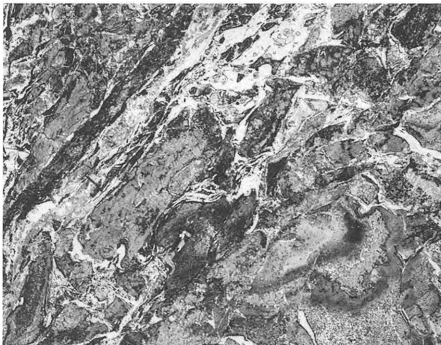
第9図 吉和層群のハイアロクラストイトの顕微鏡写真。ガラスの形態を残しているが、大部分が細粒の緑れん石の集合となっている。GSJ R43096 (林道小川線)。写真の長辺は6.5 mm。
