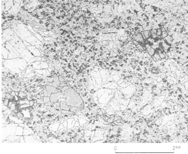
pl: 斜長石 ol: 橄欖石 aug: 普通輝石 1. 普通輝石橄欖石玄武岩 (No.125), “鮮新世” 火山岩類
