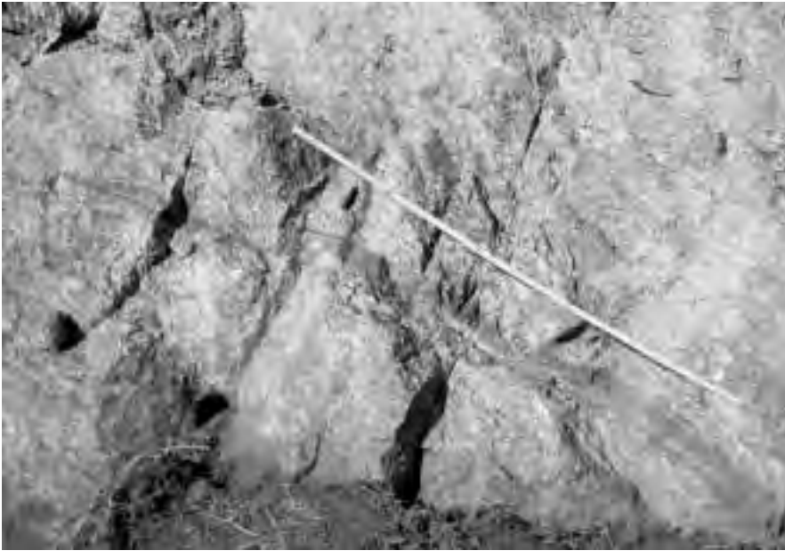
第 6.5 図 神原トータル岩中の細粒 苦鉄質同時性岩脈（蒲郡 市蒲郡調整池西岸） 岩脈は厚さ約 10 cm，長 さは約 1 m で左端でせん 滅し，更に左方に長さ 40 cm ほどのレンズ状の 苦鉄質岩も見られる。な お，この露頭ではほかに 同様の岩脈が 3 列見られ る。これらの岩脈は母岩 の片麻状構造（走向傾斜 は N75°W33°NE）に対し 調和的に貫入する。
