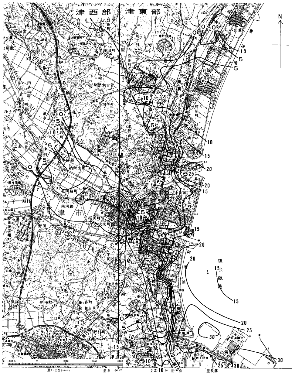
第 67 図 津市における洪積層（上部更新統）層厚線図 荒木（1980）. 単位 (m). 国土地理院発行 5 万分の 1 地形図「津東部」及び「津西部」の一部を使用.
