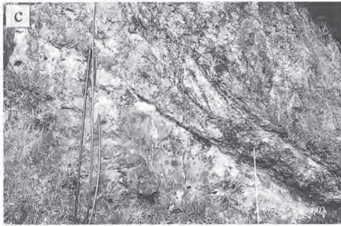
c: 水間断層の露頭. スケールは1m. 断層面の走向傾斜は, E-W, 40° N. (奈良市水間)
