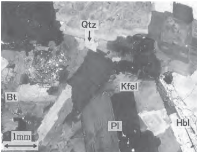
第39図 山城花崗岩の顕微鏡写真 (GSJ R 68256) Pl:斜長石, Qtz:石英, Kfel:アルカリ長石, Bt:黒雲母, Hbl:普通角閃石
