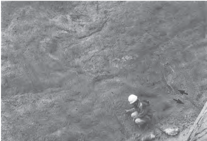
第83図 木津川断層におけるトレンチ調査 人の指先の位置に中世の瓦器片が含まれていた。矢印は断層活動の方向を示す。
