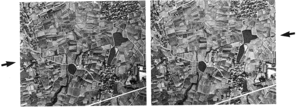
第65図 坊島断層による段丘面の変位 (箕面市西坊島) 矢印は断層の位置を示す。
