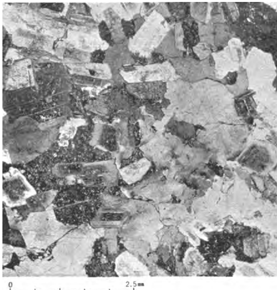
図版 15 市田花崗岩：細粒黒雲母花崗岩（与田切川上流） 斜長石は汚濁した内核部をもつ
