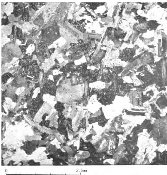
図版 16 太田切花崗岩：細粒（白雲母）黒雲母花崗岩（太田切黒川下流） 斜長石は短冊状を呈する
