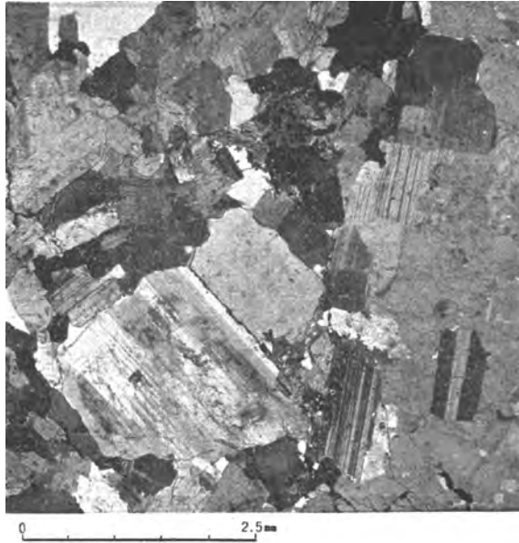
図版 19 伊奈川花崗岩：粗粒角閃石黒雲母花崗閃緑岩（南駒ガ岳南方） 斜長石をポイキリティックに含むカリ長石大晶（右方）
