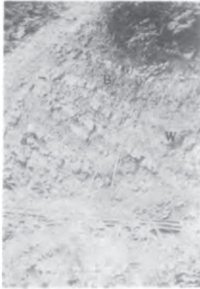
W : 白色部の優勢な凝灰角礫岩 B : 黒色部の優勢な凝灰角礫岩
