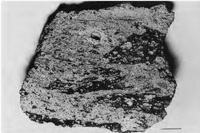
第57図 上宝火砕流堆積物(流紋岩溶結凝灰岩)のニュータキサイト構造 黒色ガラス質石基をもつ黒雲母流紋岩質の本質レンズのほかに、灰色・縞状のレンズ(かんらん石を含む)が上端にみられる。中央上部の球状体は空隙を含む黄褐色火山灰、スケールの長さ 1 cm
