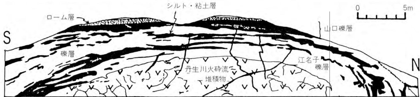
第63図 江名子断層(分岐断層)による江名子礫層の変形 (高山市江名子町上江名子) 写真の左から右へわずかに下る原傾斜を持って堆積していた江名子礫層・山口礫層が、江名子断層の分岐断層の南上がりの断層運動で、撓曲・逆傾斜したものである。断層は丹生川火砕流堆積物の右端部付近の地下に推定されている。露頭右端の江名子礫層は特に大きく変形し、一部には地層の逆転も認められる。露頭スケッチは鹿野(1983)による
