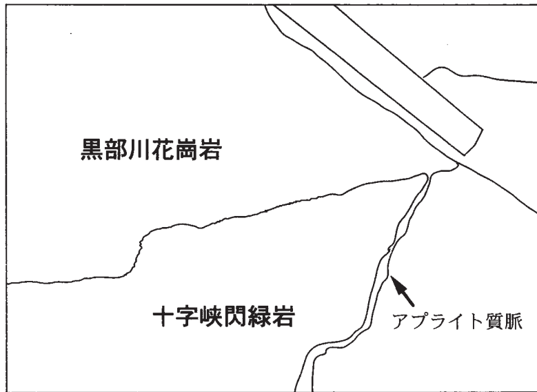
第70図 十字峡閃緑岩と黒部川花崗岩の接触関係 GSJ R69038 (TT128) : 仙人ダム南東送電線鉄塔 (no.2) 基部 (標高1,030m)
