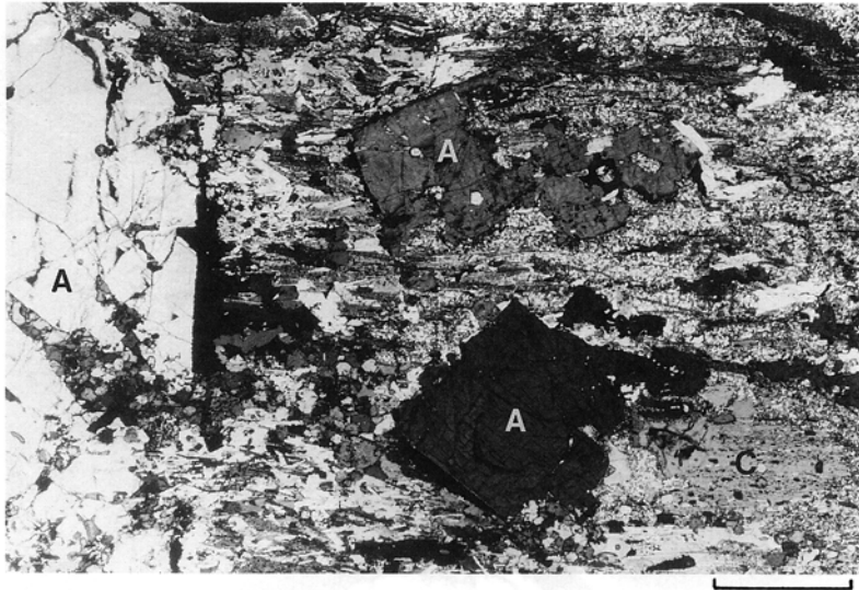
第 16 図 珪線石帯の泥質変成岩の薄片写真 紅柱石(A), 堇青石(C), およびカリ長石斑状変晶を含み少量のフィブロライトを伴う。 高遠町薬師堂の試料(試料番号 FJR 022). スケール: 0.2mm
