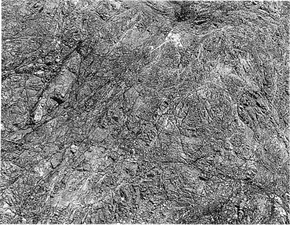
第 41 図 寄居酸性岩類の流紋岩溶結凝灰岩 破碎が強く、密に発達した割れ目により径数cm以下に割れ易い。また、割れ目に沿ってはしばしば方解石脈が入っている。写真の横幅約1.2m (寄居町正喜橋のすぐ下流、荒川と深沢川の合流点近く)
