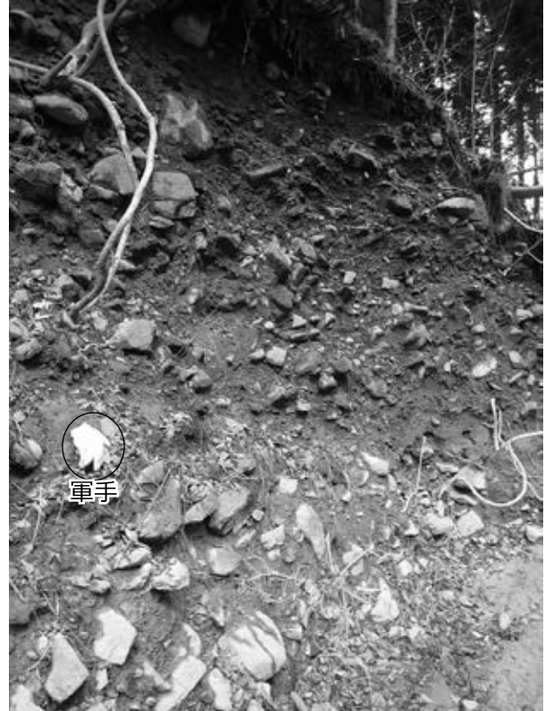
第 7.5 図 山麓及び埋谷緩斜面堆積物 (p) に区分した崖錐堆積物の露頭写真 (大子町野出畑)
