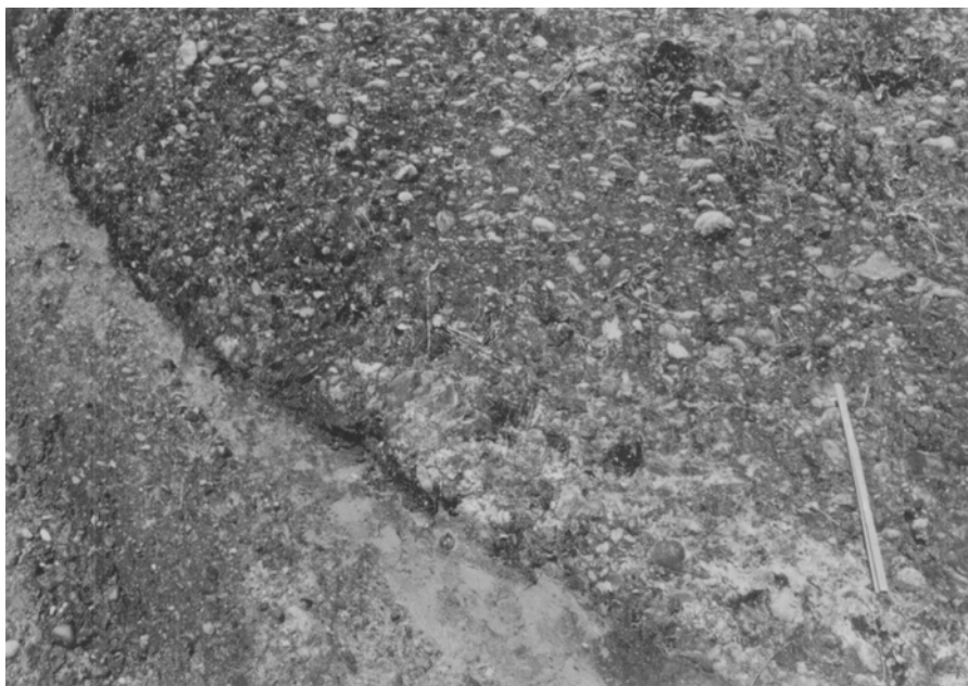
第 58 図 櫛平層下部に見られる覆瓦構造のある礫岩 スケールは約 50 cm. (広野町荒神の県道沿いの崖. 位置は付図第 1 図に示す)
