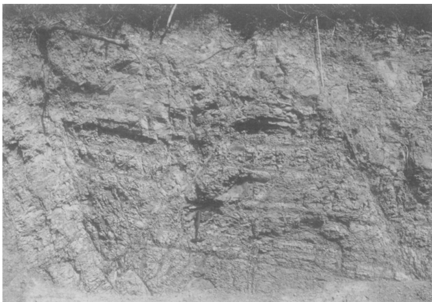
第 51 図 石城層_上部 (Iw2) の砂岩 細粒砂岩中に灰色泥岩の薄層 (厚さ 2-5 cm) を多数挟む. 共役の小断層が多数発達する. ハンマーの長さは約 32 cm. (広野町夕筋西方約 2 km の林道沿い. 位置は付図第 8 図に示す.)
