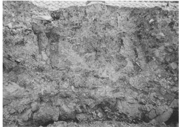
第38図 寺泊層の砂岩泥岩互層を母岩とする地すべり堆積物 寺泊町野積の大河津分水路左岸.
