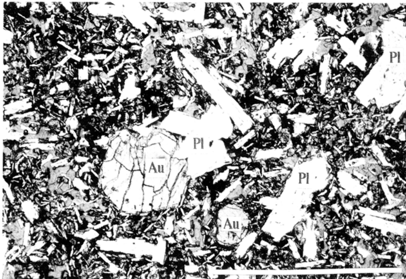
第10図 砂子湖層のかんらん石普通輝石玄武岩の顕微鏡写真(GSJ R60425) スケールは1mm. Pl=斜長石; Au=普通輝石
