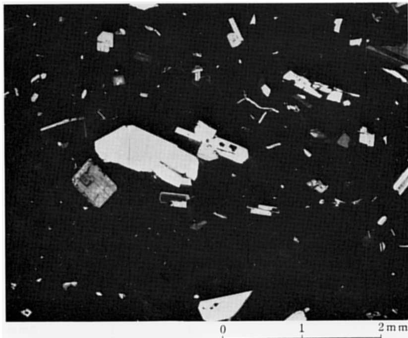
2. 素波里安山岩の紫蘇輝石黒雲母含有角閃石ディサイトの顕微鏡写真（溶岩） 採集地：能代市大柄北方約2.8km常盤川沿い，NS 294
