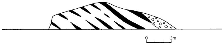
第11図 和田川層の泥質岩互層状況を示すスケッチ（水ヶ沢山北東方小湊越林道） 黒色部：珪質頁岩，白色部：軟質泥岩，礫状部：崖錐
