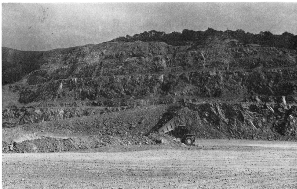
第20図 B 鉱床の採掘現場。ベンチカット方式で採掘。トラックが縦穴に石灰岩を落とし、地下内に待機する貨車に着よ込まれる。
