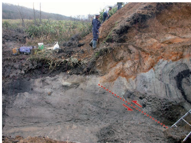
写真1 黒松内低地断層帯のトレンチ調査で観察された断層構造と地層の変形。
