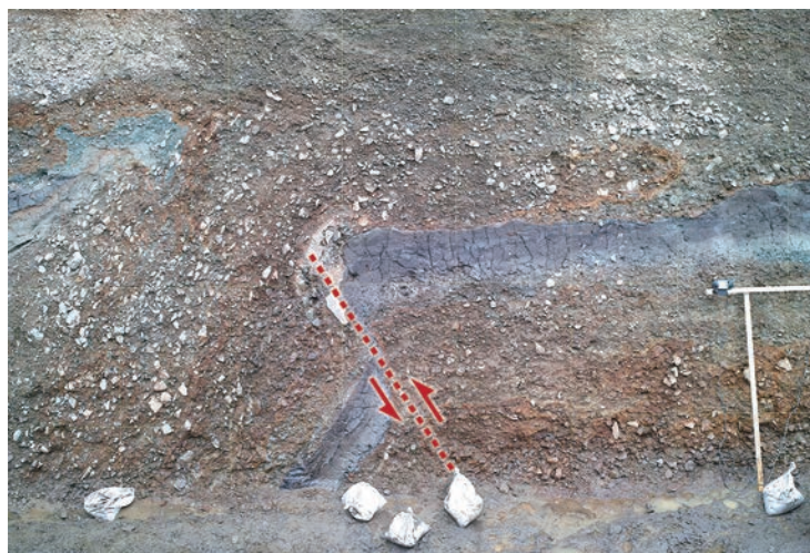
写真2 十勝平野断層帯南部（光地園断層）のトレンチ調査で観察された断層構造。
