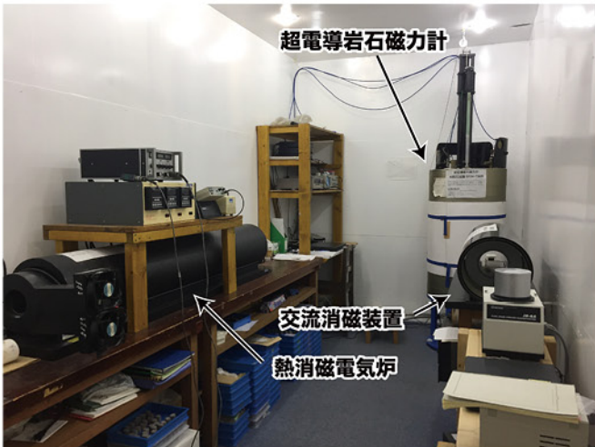
茨城大学の古地磁気実験室。装置は鉄板に囲われた小部屋に設置されており、現在の地磁気を遮断しています
