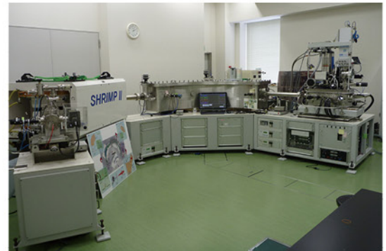
ジルコンの年代決定に使用された二次イオン質量分析計"SHRIMP"(国立極地研究所設置)。一粒一粒のジルコン結晶の特定の点の年代測定が可能。(写真提供: 堀江憲路氏)
