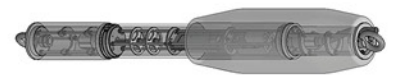
図2 開発したストリーマケーブルの受波部 図は1チャンネル分で、これを連結することでマルチチャンネルにできます。チャンネル間の長さも自由に変えることができます。今回は12個を連結しました。デジタルデータを収録して、イーサネットにてデータ通信を行います。
