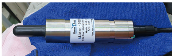
写真1 水中音の録音装置 (株) 昌新/ (株) KANSO テクノス提供
