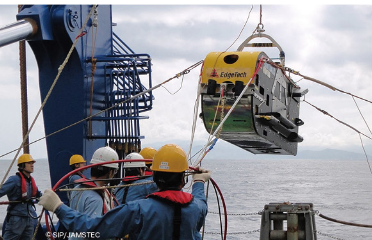
写真1 深海曳航体（DT-2）の投入作業
