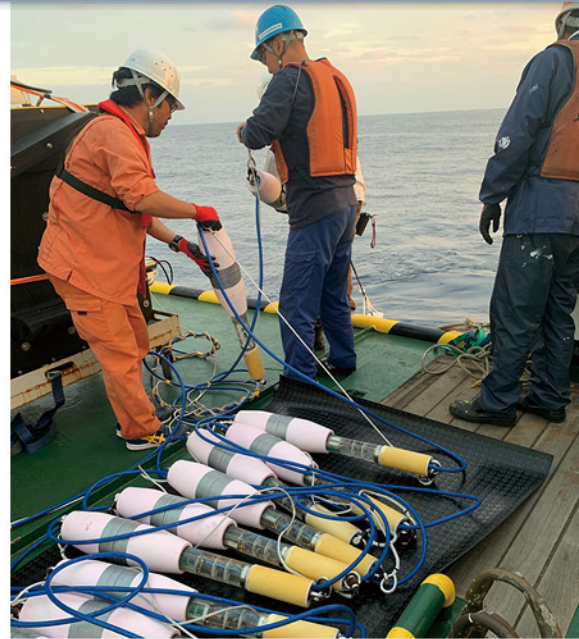
写真 深海曳航ストリーマケーブルの投入作業
