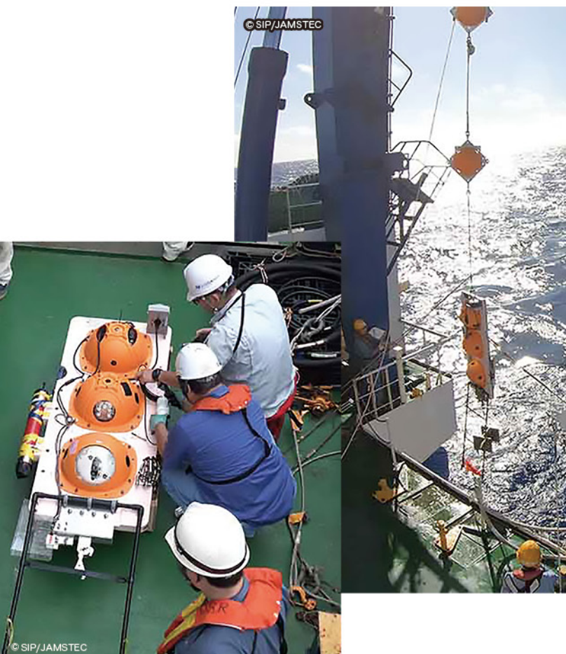
写真2 江戸っ子1号 HSG 型の観測プラットフォームの船上準備 (左)、投入作業 (右)
